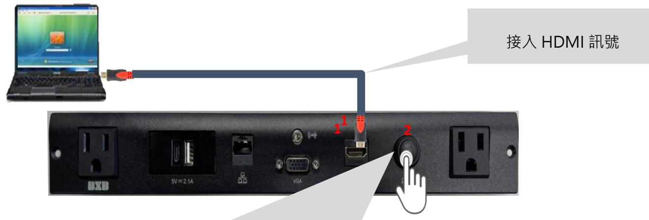
HDMI訊號輸入後(確實插入HDMI接頭)
